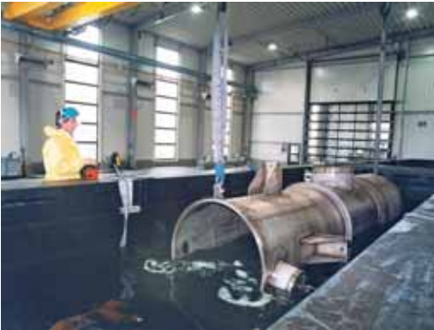
Abb. 2: Bei einem herkömmlichen Tauchbeizbecken mit einer durchschnittlichen Beizbadoberfläche von zehn Quadratmetern müssen stündlich 10 000 Kubikmeter gesundheitsschädliche Abluft gefiltert werden
